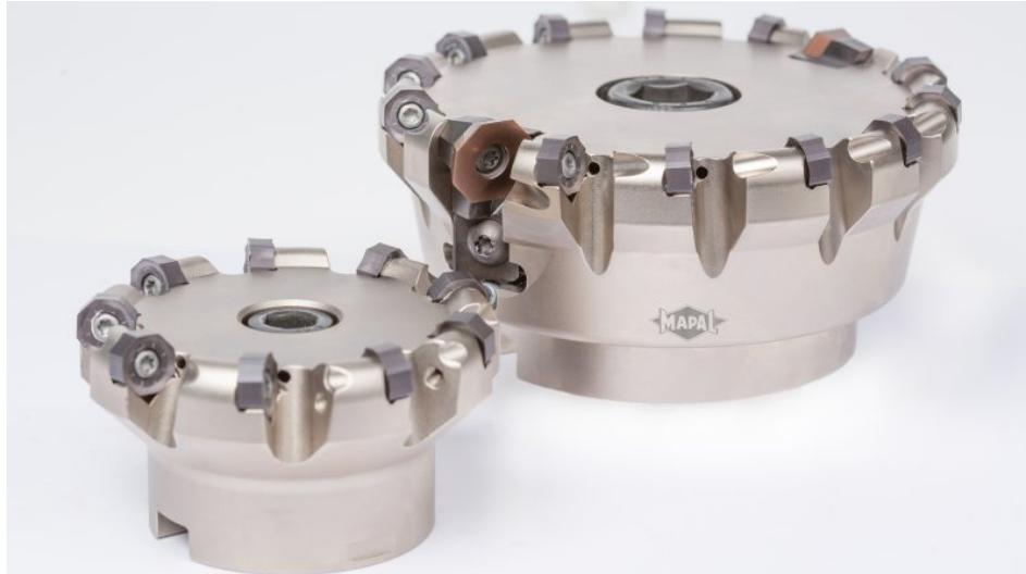
»NeoMill-16-Finish« mit der Kombination aus 16-schneidiger Vorbearbeitungsschneide und 8-schneidiger Wendeschneidplatte zum Schlichten von Stahl- und Gusswerkstoffen. »NeoMill-16-Face« steht für eine effiziente Vorbearbeitung beim Planfräsen (Bild: Mapal).
