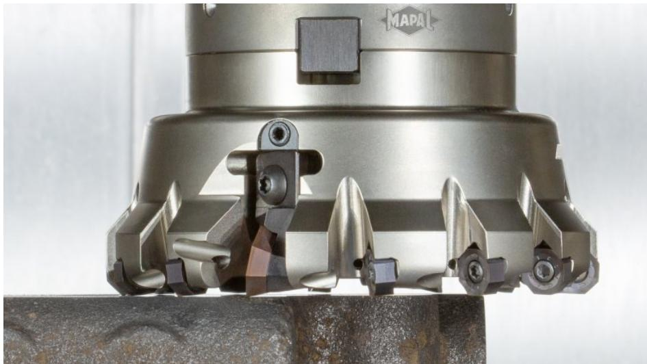
»NeoMill-16-Finish« bei der Bearbeitung eines Guss-Bauteils (Bild: Mapal).
