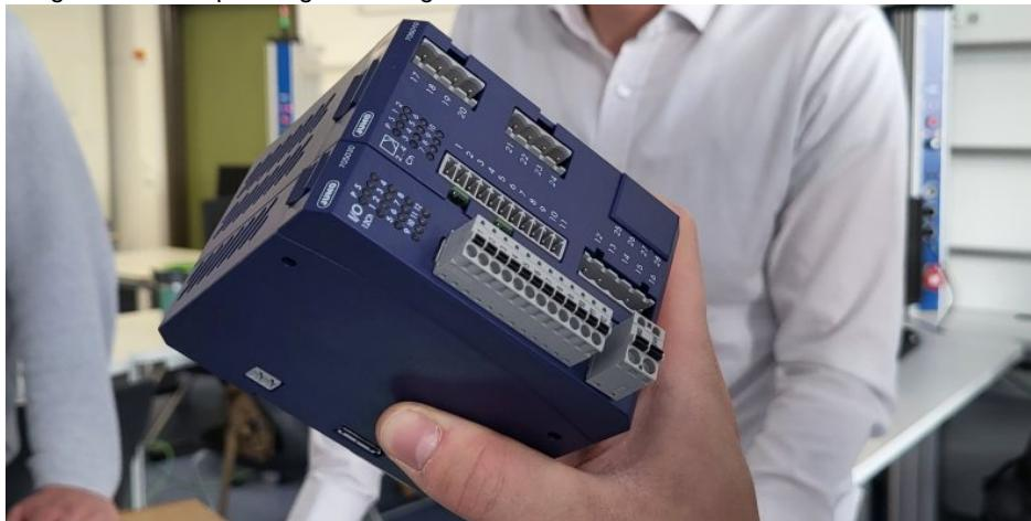
Das SPS-System »variTRON 500 touch« ermöglicht einen praxisnahen Unterricht mit moderner Steuerungstechnik (Bild: Jumo).
