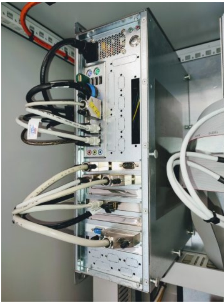
Das Positioniersystem als Industrie-PC im Schaltschrank einer Fräsmaschine (Bild: Lang).
