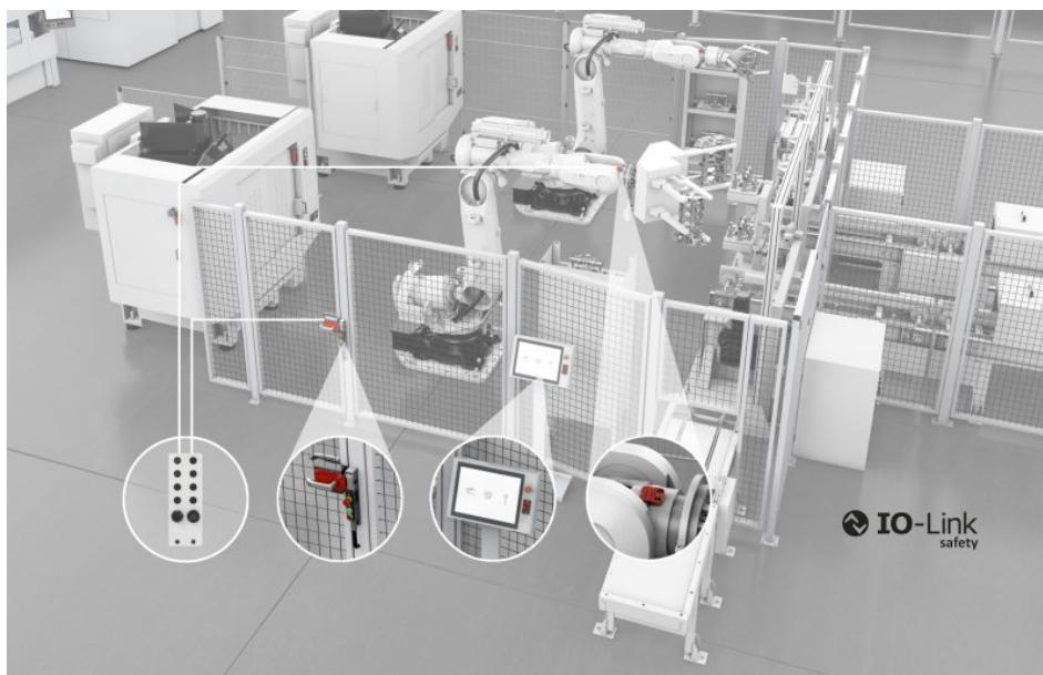
Die bewährten und robusten Sicherheitskomponenten werden mit den Vorteilen der sicheren Kommunikation über IO-Link Safety kombiniert (Bild: Euchner).
