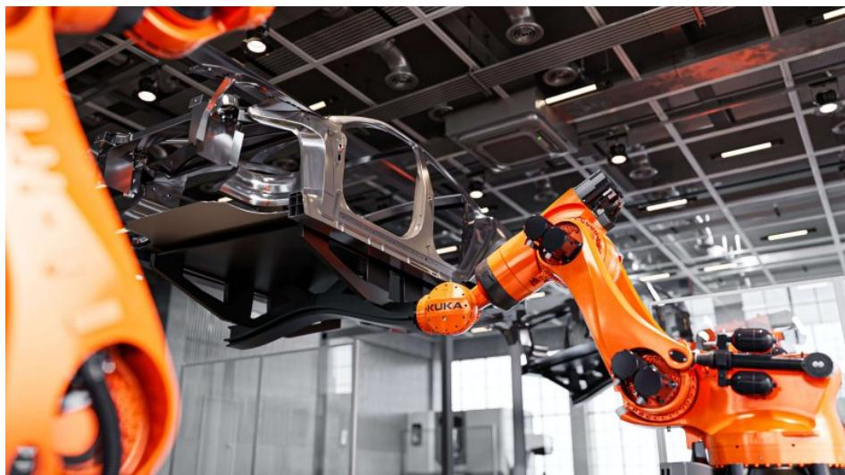
Der Roboter bietet bis zu 1,5 t Traglast bei vergleichsweise geringem Eigengewicht
