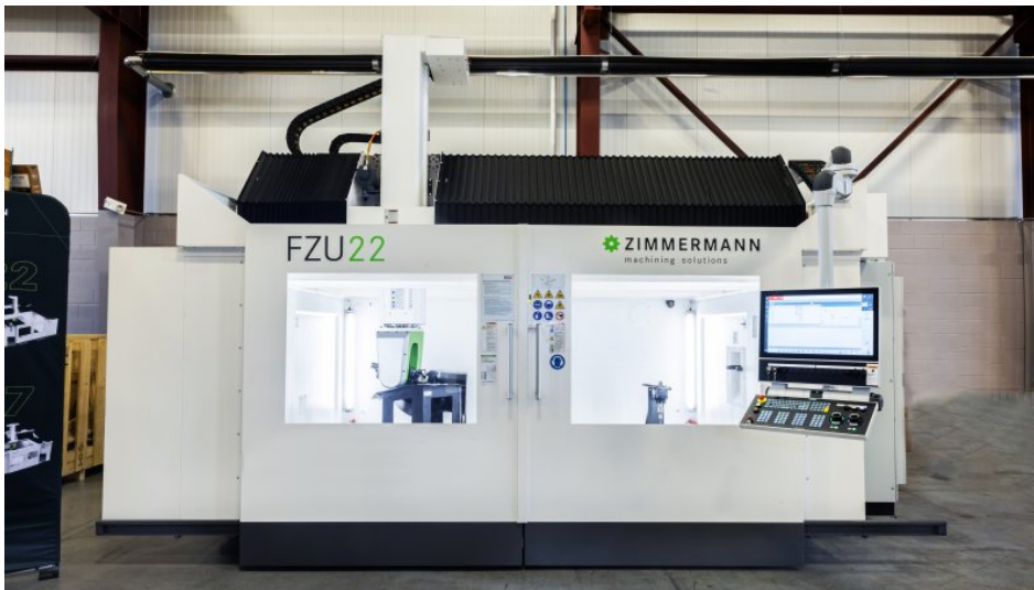
Kompakte Portalfräsmaschine (Bild: F. Zimmermann).
