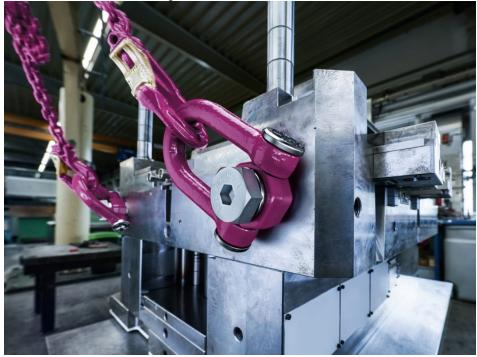
Anschlagpunkt »ACP-Turnado« zum Drehen und Wenden von Lasten (Bild: EMO).
