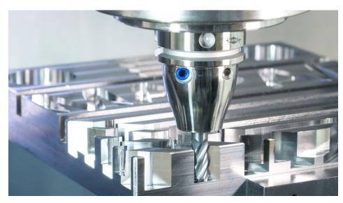
Die dritte Generation des Vollhartmetallfräsers »Optimill-Uni-HPC« wurde speziell für moderne, automatisierte Fertigungsprozesse entwickelt (Bild: Mapal).
