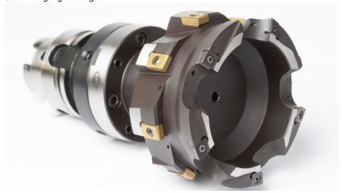
Kombinationswerkzeug mit ISO-Vorschneidstufe und »HPR400«-System (Bild: Mapal).
