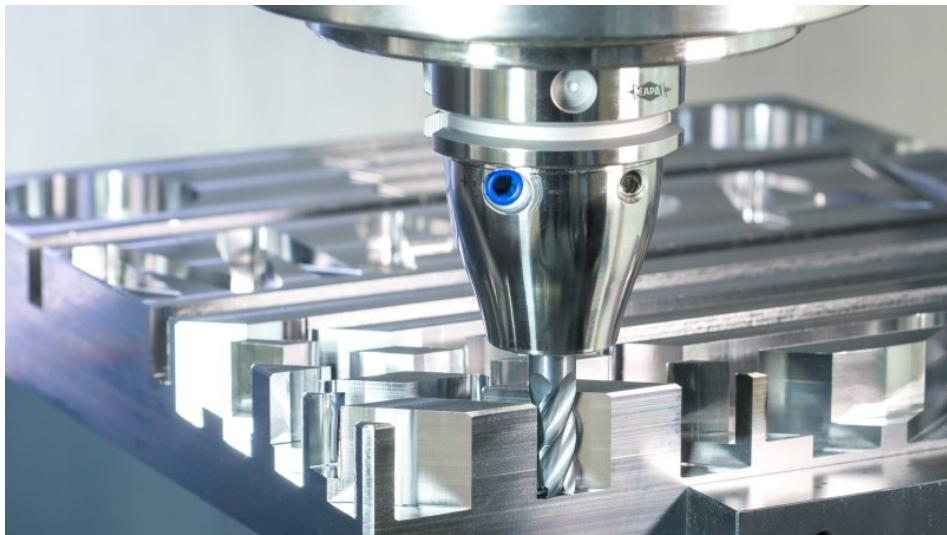
Die dritte Generation des Vollhartmetallfräzers »Optimill-Uni-HPC« wurde speziell für moderne, automatisierte Fertigungsprozesse entwickelt (Bild: Mapal).
