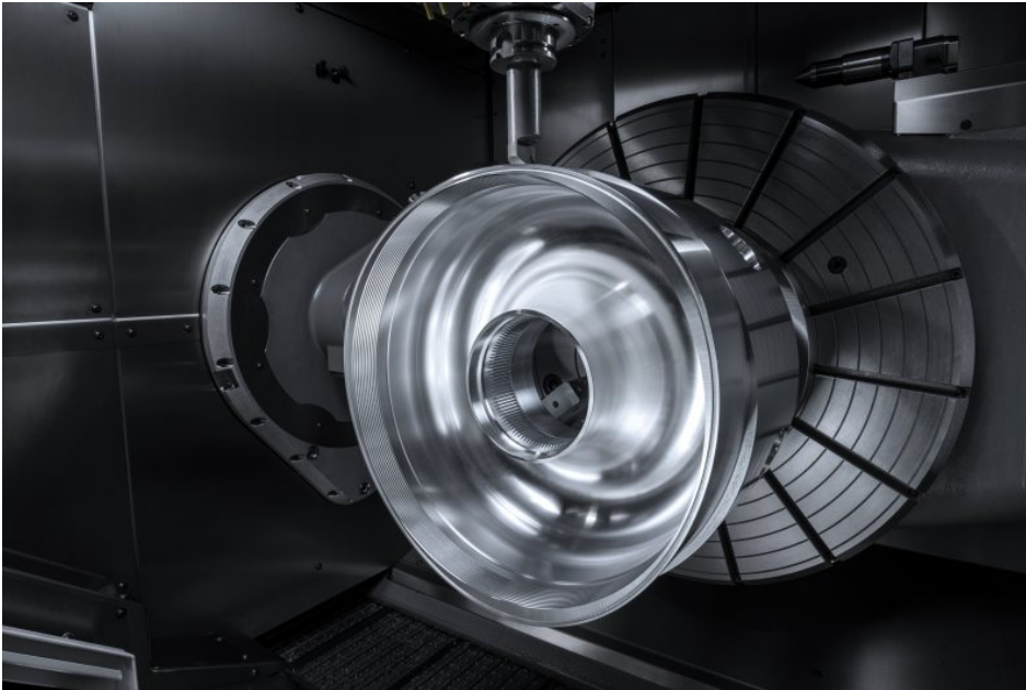
Bearbeitung eines Werkstückes mit unterschiedlichsten Drehzyklen (Bild: Hermle).
