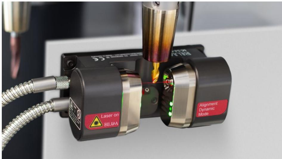
Das System kann für die Vermessung von Standard- und Mikrowerkzeugen im Bereich von 10 µm bis 16 mm im Durchmesser eingesetzt werden (Bild: Blum).
