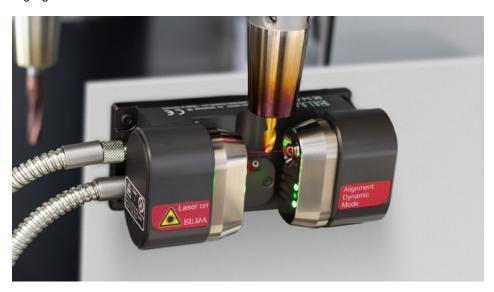
Das System kann für die Vermessung von Standard- und Mikrowerkzeugen im Bereich von 10 µm bis 16 mm im Durchmesser eingesetzt werden (Bild: Blum).
