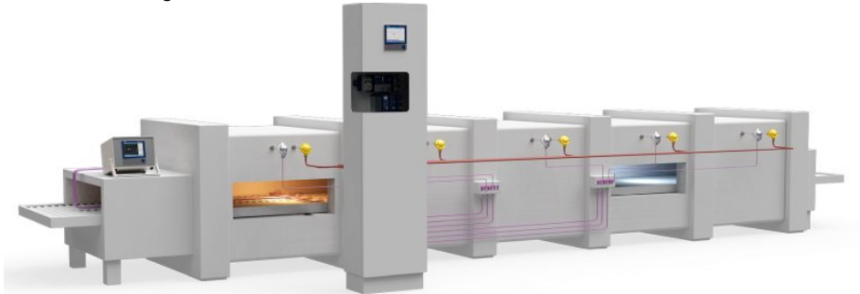
Durchlaufofen mit Bildschirmschreiber »Logoscreen 700« (Bild: Jumo).
