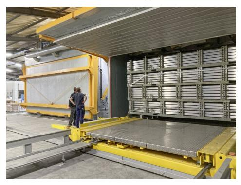
Einer der drei Kammeröfen der Aluminiumwerke Wutöschingen: Heizleistung 1000 Kilowatt; Ofengröße 87 Quadratmeter, Arbeitsvolumen 43 Kubikmeter, Kalibrierung gemäß Prozesstabelle CQI-9 (Bild: Jumo).
