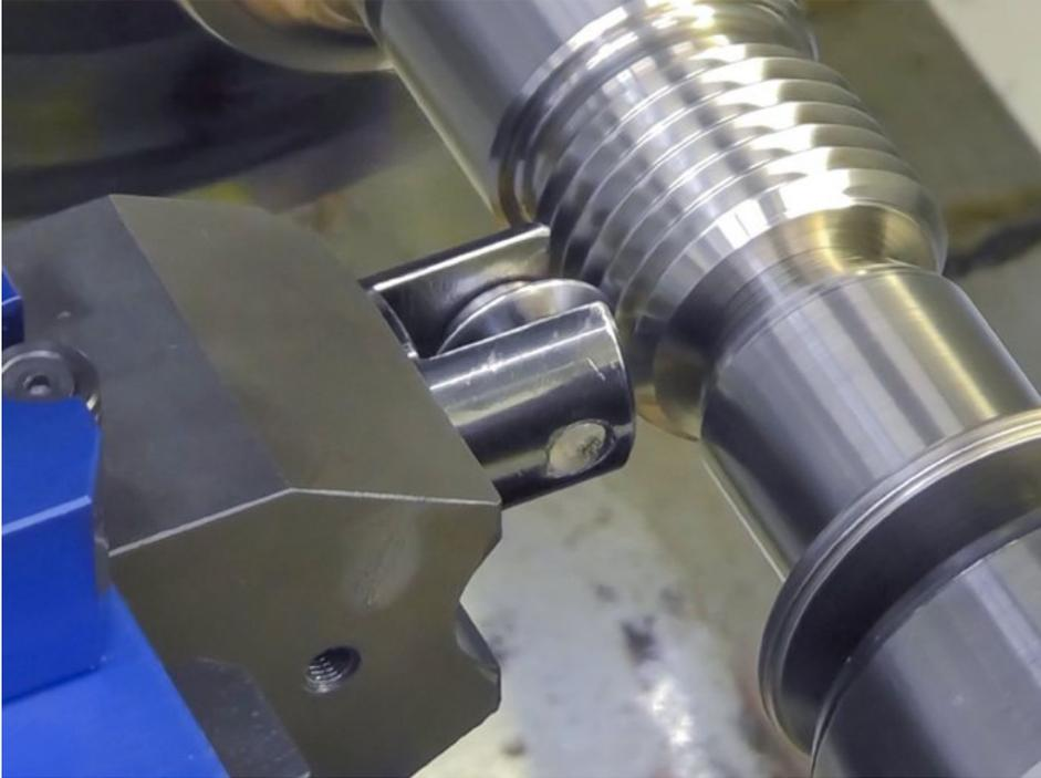
Gewindebearbeitung mit einrolligem Festwalzwerkzeug »EF90« (Bild: Ecoroll).
