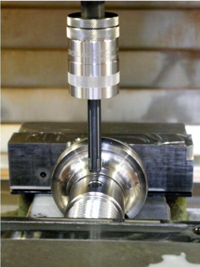
Bohrungsbearbeitung mit »G-Werkzeug« (Bild: Ecoroll).
