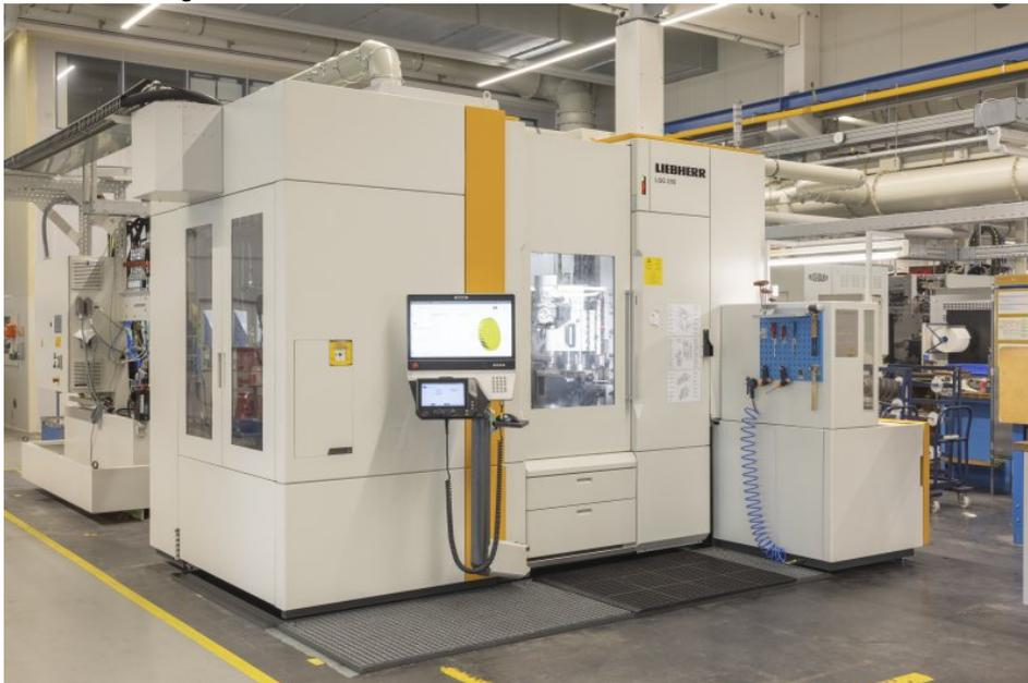
Eine besonders hohe Profilgenauigkeit beim Schleifen erreicht die Wälz- und Profilschleifmaschine »LGG 280« (Bild: Liebherr).
