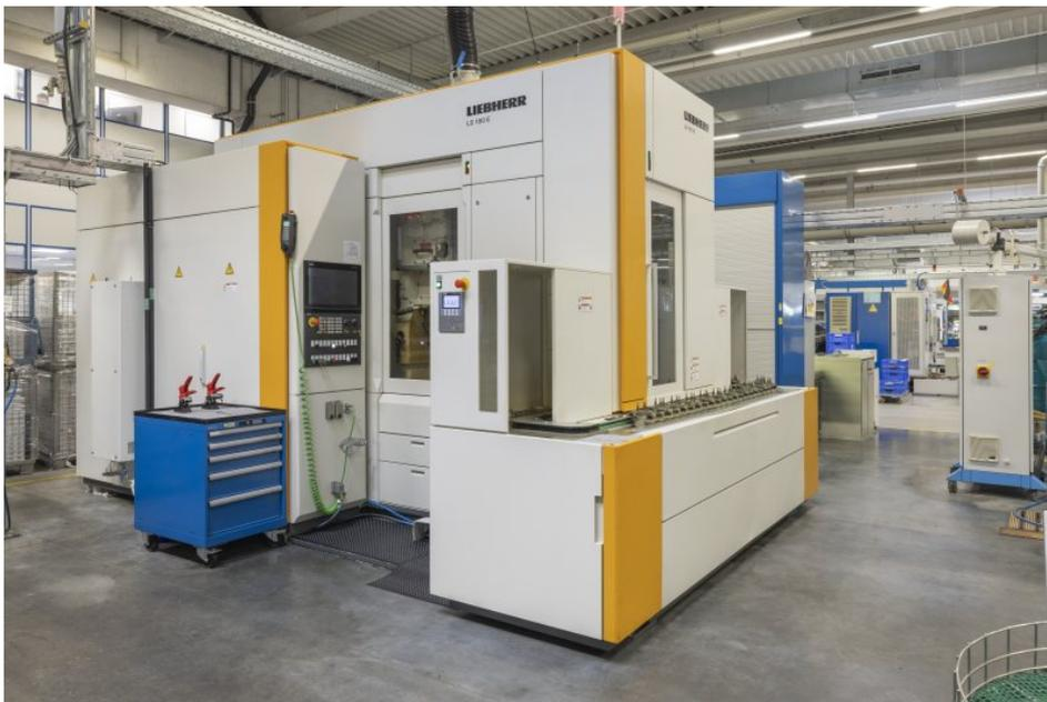
Die Wälzstoßmaschine bewältigt ein breites Teilespektrum und sorgt für kurze Rüstzeiten. Damit eignet sie sich besonders für den Einsatz bei Lohnverzahnern (Bild: Liebherr)
