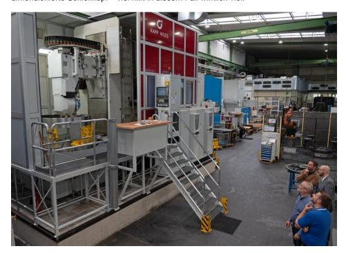
Eine Besonderheit der Schleifmaschine ist, dass sich der Schleifkopf wenden und so in sehr kurzer Zeit von Innen- auf Außenverzahnung umrüsten lässt (Bild: Martin Witzsch)
