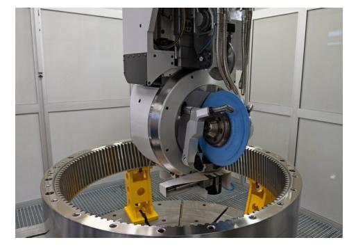
Die Schleifscheibe der Schleifmaschine »ZP I/E 25« ist einseitig gelagert und lässt sich mit wenigen Handgriffen wechseln (Bild: Martin Witzsch).
