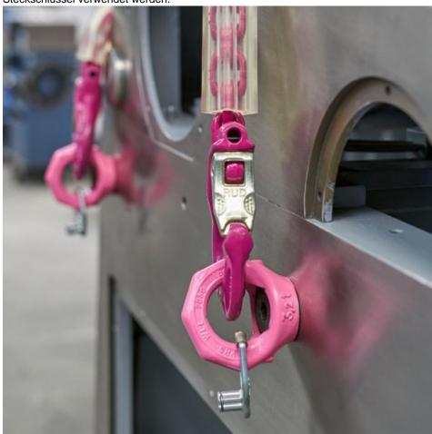
Der robuste Sternprofilschlüssel der »VRS«-Ringschraube dient als Inbusersatz und ist unverlierbar am Ringkörper befestigt und damit immer griffbereit (Bild: RUD).
