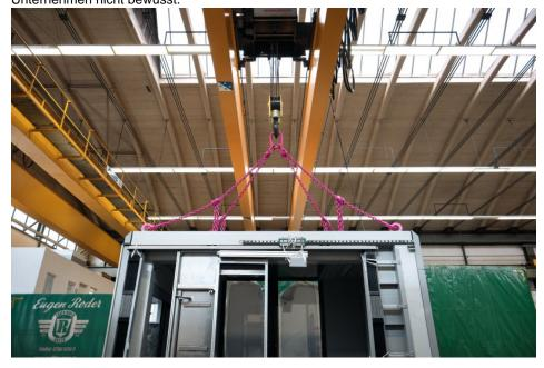
Der drehbare Ringkörper der Ringschrauben richtet sich automatisch in Richtung der Krafteinwirkung aus, sobald er beim Heben belastet wird. So lassen sich die meisten Risikofaktoren des Ringschraubeneinsatzes minimieren (Bild: RUD).
