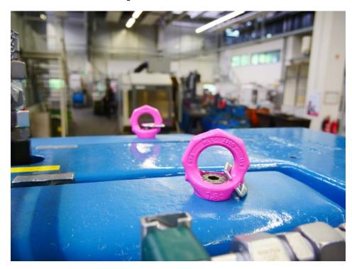
Gefertigt aus hochfestem Vergütungsstahl, ist die »VRS«-Serie mit Nenntragfähigkeiten von 0,1 bis 20 Tonnen und in den Gewindegrößen M6 bis M64 erhältlich (Bild: RUD)
