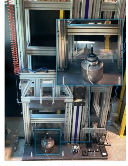
Mit Tests am Falltestprüfstand validiert ACE die für den Notstopp ermittelten kundenspezifischen Werte der maximalen Energieaufnahme von Kleinstoßdämpfern (Bild: ACE).
