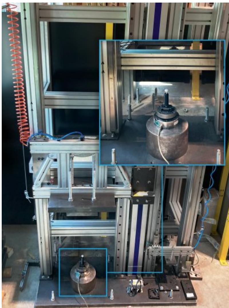
Mit Tests am Falltestprüfstand validiert ACE die für den Notstopp ermittelten kundenspezifischen Werte der maximalen Energieaufnahme von Kleinstoßdämpfern (Bild: ACE).
