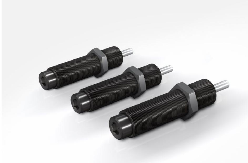
Die Kleinstoßdämpfer von ACE sind in den Größen M14, M20 und M25 lieferbar, bieten eine Energieaufnahme von 20 bis 136 Newtonmeter pro Hub bei einem Hub von 12 bis 25 Millimetern und passen so gut wie in jede neue oder bestehende Konstruktion (Bild: ACE).
