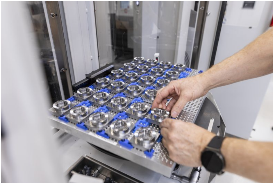
Entnahme der Werkstücke von der Condor-Universalmatrize (Bild: Hermle).
