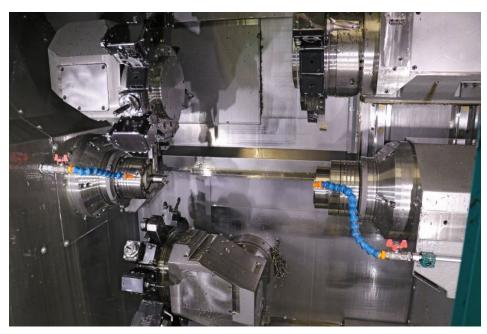
Schumag setzt die Produktionsdrehautomaten zur Bearbeitung komplexer Bauteile im Durchmesserbereich 15 bis 65 Millimeter ein. Aus den drei Revolvern und großen Verfahrwegen resultieren eine hohe Flexibilität und kurze Taktzeiten (Bild: Index).
