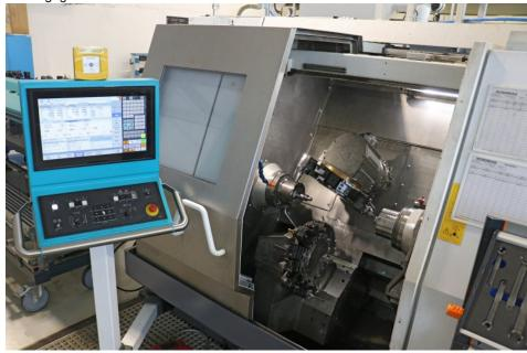
Fünf der sieben bei Schumag befindlichen Dreh-Fräszentren »G200« stammen aus dem Refit-Programm von Index. Sie bieten eine sehr hohe Präzision und ein Maschinenkonzept, das durch seine y/b-Achse im oberen Werkzeugträger für die Komplettbearbeitung anspruchsvoller Teile geeignet ist (Bild: Index).
