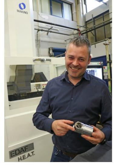
Christoph Daniels, Leiter Productivity, freut sich über die neue Erodiermaschine »EDAF3« von Makino, die unter anderem zum Erodieren der Notlaufflächen an »Tapped Bodys« eingesetzt wird (Bild: Index).
