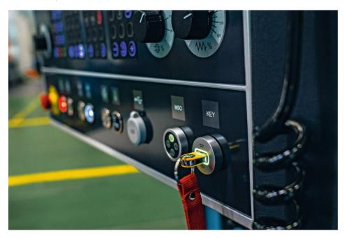
Das neue Zugangsberechtigungssystem fügt sich in das Maschinendesign ein. Das Bedienpersonal authentifiziert sich einfach mit seinem individuellen Schlüssel (Bild: Starrag).
