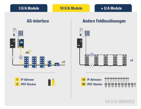
Vergleich des Bedarfs an IP-Adressen und IP67-Steckern für die Integration von 10 E/A-Modulen (Bild: Bihl+Wiedemann).
