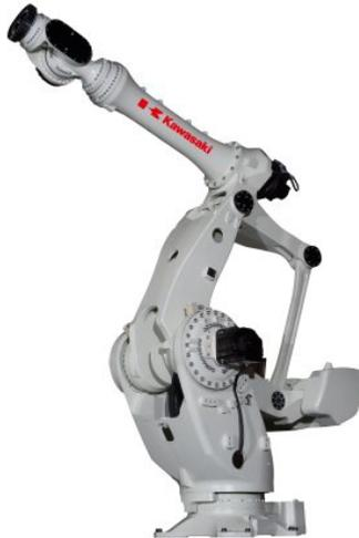
Neuer Industrieroboter mit 710 kg Tragkraft (Bild: Kawasaki).
