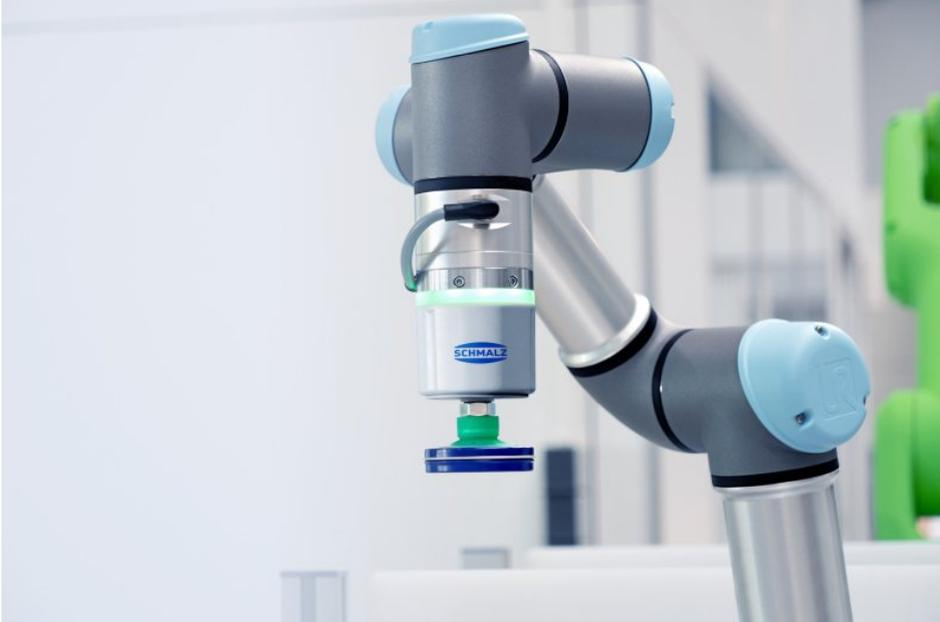
Geringe Abmessungen und geringes Gewicht prädestinieren den Vakuumerzeuger »ECBPMi« für Roboter mit Traglasten bis 3 kg (Bild: Schmalz).
