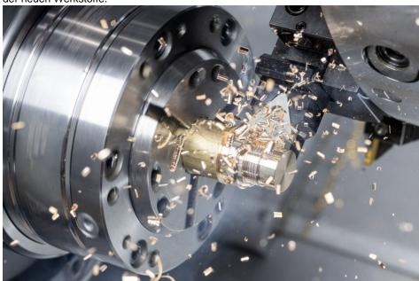
Angepasste Schneidengeometrien verschaffen bei der Zerspanung von bleifreien Werkstoffen ein hohes Maß an Prozesssicherheit (Bild: Horn/Sauermann).
