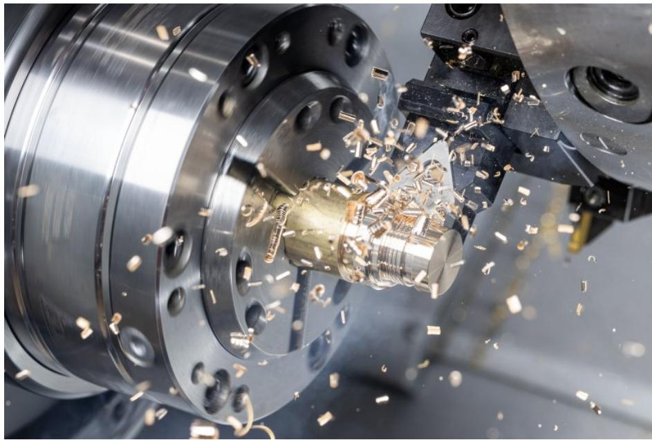
Anangepasste Schneidengeometrien verschaffen bei der Zerspanung von bleifreien Werkstoffen ein hohes Maß an Prozesssicherheit (Bild: Horn/Sauermann).
