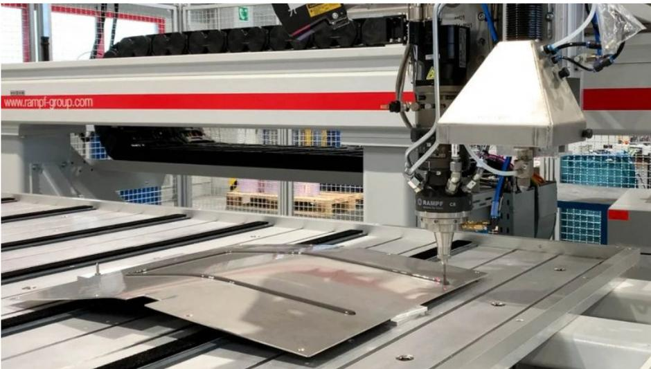
Selbst auf einer unlackierten Hochglanzoberfläche stellt der Auftrag des 2K-Polyurethan-Dichtungsschaums kein Problem dar (Bild: Rampf).
