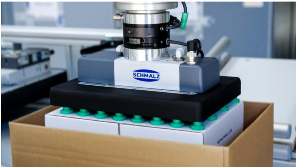
Der neue Flächengreifer ermöglicht ein passgenaues und sicheres Handling ganz individuell geformter Werkstücke (Bild: Schmalz).
