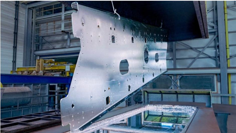
Die verzinkten Seitenteile des Siebkastens sind 2,5 m hoch, 5 m lang und 8 mm stark. Ihr Gewicht beträgt eine Tonne (Bild: Zinq).
