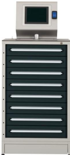
Schublade auf und Werkzeug entnehmen – so einfach kann die automatisierte Werkzeugausgabe sein (Bild: Hahn+Kolb).
