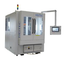
Die automatisierte Entgratzelle ermöglicht die Bearbeitung unterschiedlicher Bauteile (Bild: Heitec).
