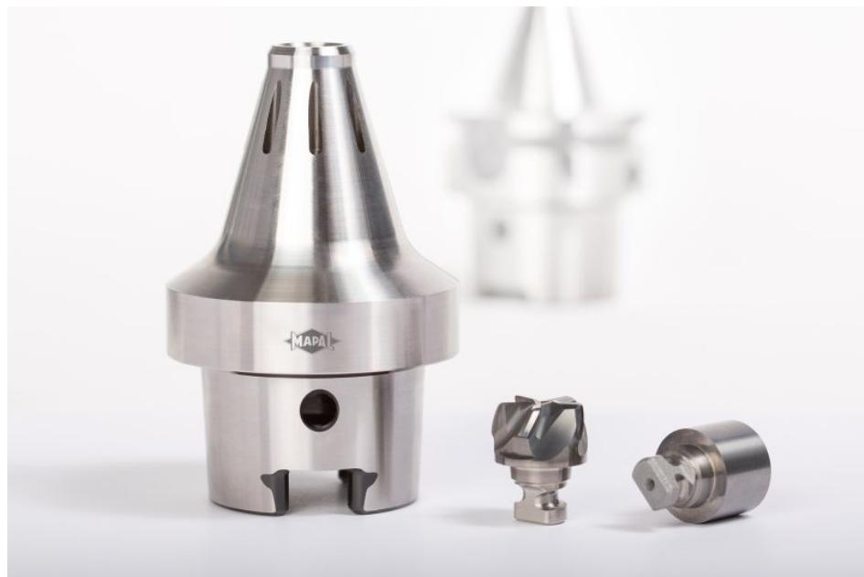
Die spezielle, bajonettähnliche Trennstelle bietet ein sehr einfaches Handling, eine steife Verbindung und optimierte Kühlung (Bild: Mapal).
