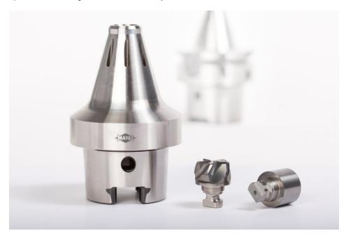
Die spezielle, bajonettähnliche Trennstelle bietet ein sehr einfaches Handling, eine steife Verbindung und optimierte Kühlung (Bild: Mapal).
