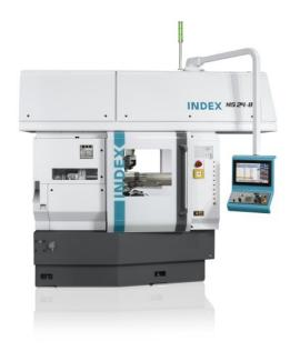
Das Kernstück des Mehrspindel-Drehautomaten ist die kompakte Spindeltrommel mit acht fluidgekühlten Motorspindeln. Mit den 16 Werkzeugträgern sowie ein oder zwei Synchronspindeln können verschiedene Bearbeitungsstrategien umgesetzt werden (Bild: Index).
