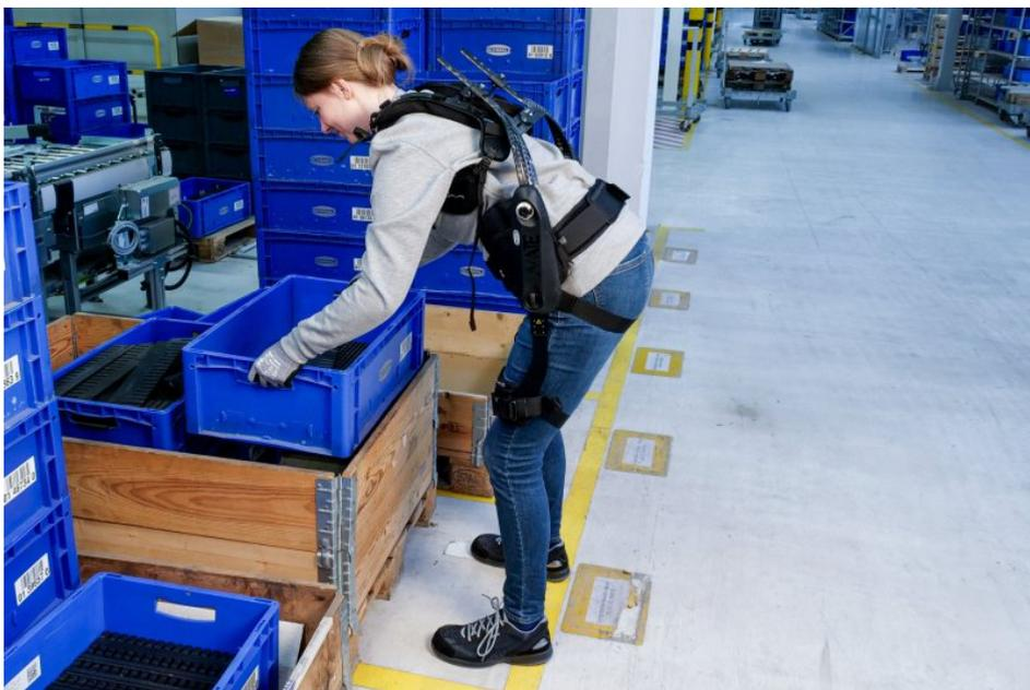
Exoskelette entlasten das Personal und tragen zur Mitarbeiterzufriedenheit bei (Bild: Schmalz).
