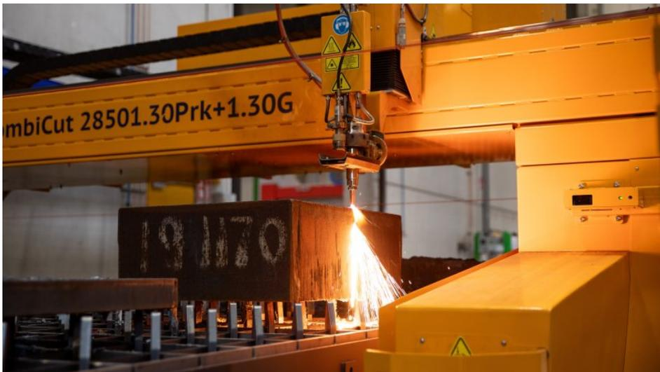
Der Autogensupport der robusten Brennschneidanlage bietet die Bearbeitung von Materialstärken bis zu 400 mm (Bild: Microstep).
