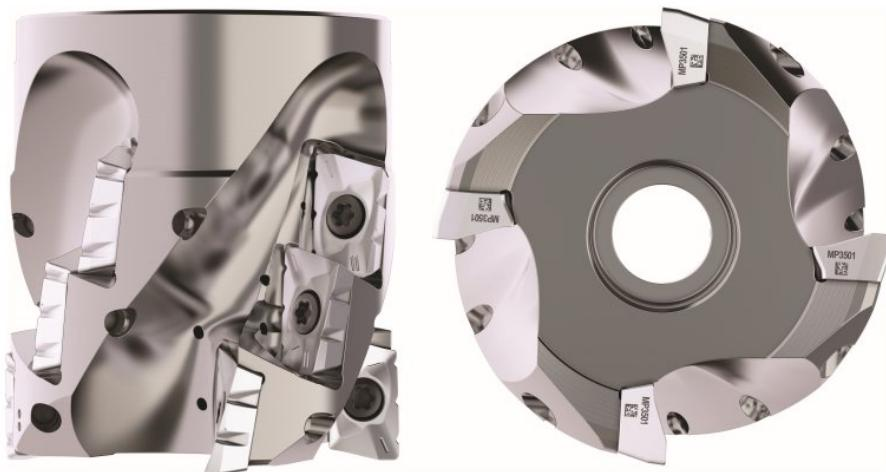
Die spezielle, mit Spanteilern versehene Geometrie der Wendeschneidplatten minimiert Vibrationen und optimiert die Spanevakuierung (Bild: Seco Tools).
