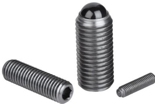
Die federnden Druckstücke von Kipp gibt es in acht Gewindegroßen von M3 bis M16 sowie mit den Montageoptionen Innensechskant oder Schlitz (Bild: Kipp).
