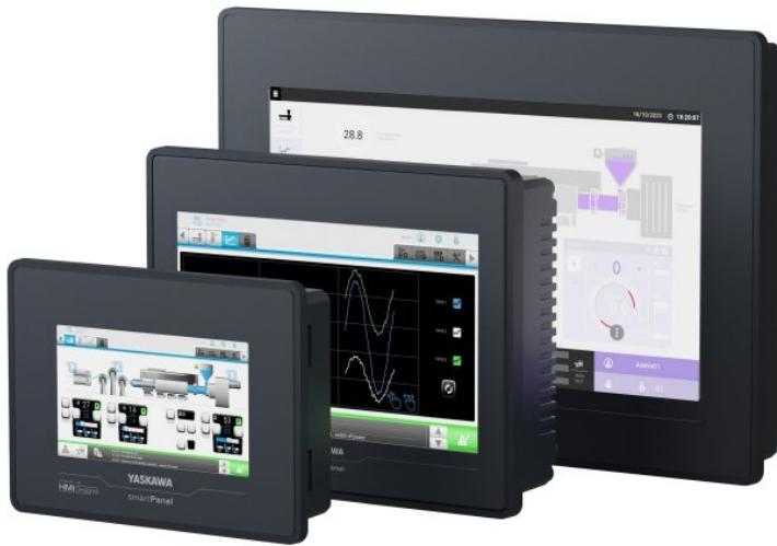
Die ARM-basierten Bedienpanels und die Panel-PCs mit Windows kommen mit neuer Soft- und Hardware (Bild: Yaskawa).
