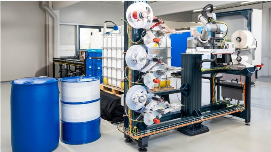
Die vollautomatische Etikettieranlage arbeitet mit Cobot, vier Etikettiersystemen und einem robotergeführten Riemenapplikator (Bild: Bluhm Systeme).
