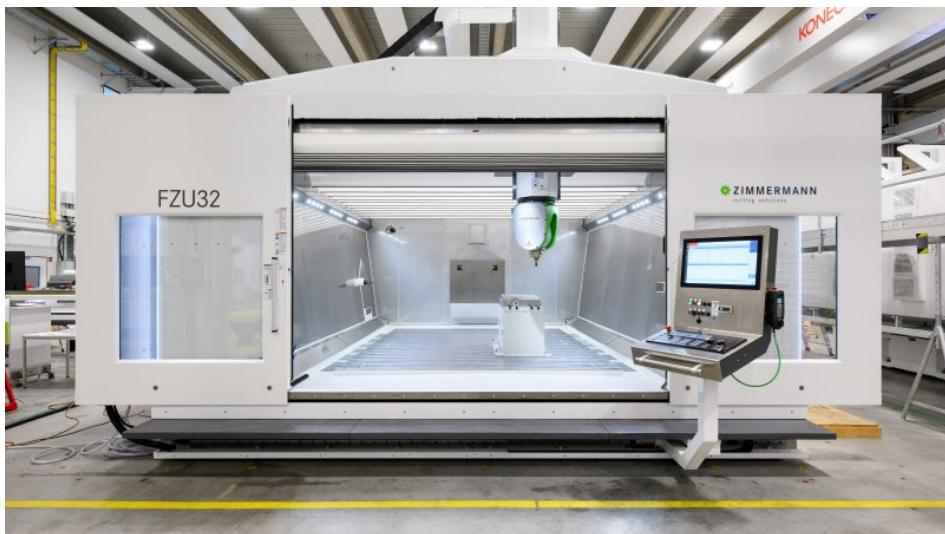
Die 5-Achs-Portalfräsmaschinen arbeiten dank ihres thermosymmetrischen Aufbaus sehr genau (Bild: F. Zimmermann GmbH).
