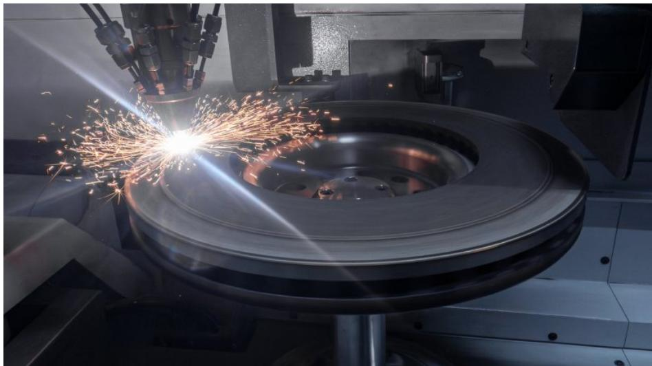
Per Laserauftragschweißen wird eine Hartstoffbeschichtung aufgebracht, die Bremsscheiben vor Korrosion und Verschleiß schützt (Bild: Emag).
