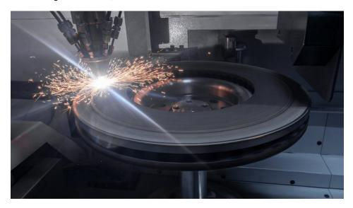
Per Laserauftragschweißen wird eine Hartstoffbeschichtung aufgebracht, die Bremsscheiben vor Korrosion und Verschleiß schützt (Bild: Emag).
