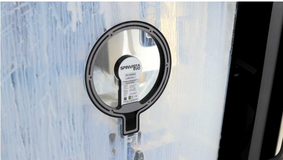
Das Drehfenster sorgt für klare Sicht in den Bearbeitungsraum der Werkzeugmaschine (Bild: Hema).
