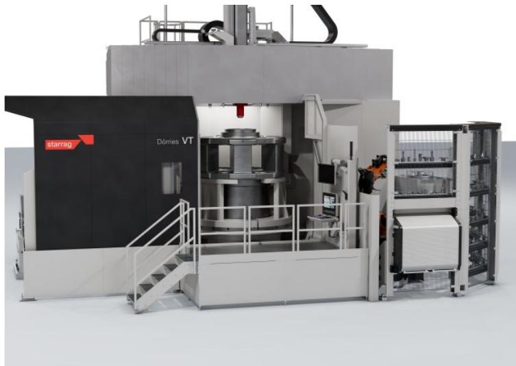
Präzise, flexibel, leistungsstark: Das neue Vertikal-Bearbeitungszentrum ermöglicht die hochgenaue Bearbeitung von 17 t schweren Bauteilen (Bild: Starrag).
