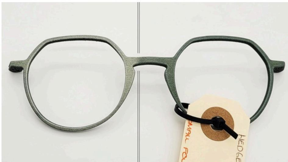
Links unbehandelt, rechts mit dem UV-Schutz behandelt, der hier ein 3D-gedrucktes Brillengestell vor dem Verblasen schützt (Bild: Diamant Polymer).
