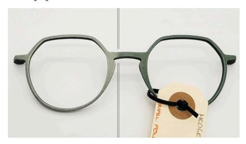
Links unbehandelt, rechts mit dem UV-Schutz behandelt, der hier ein 3D-gedrucktes Brillengestell vor dem Verblassen schützt (Bild: Diamant Polymer).
