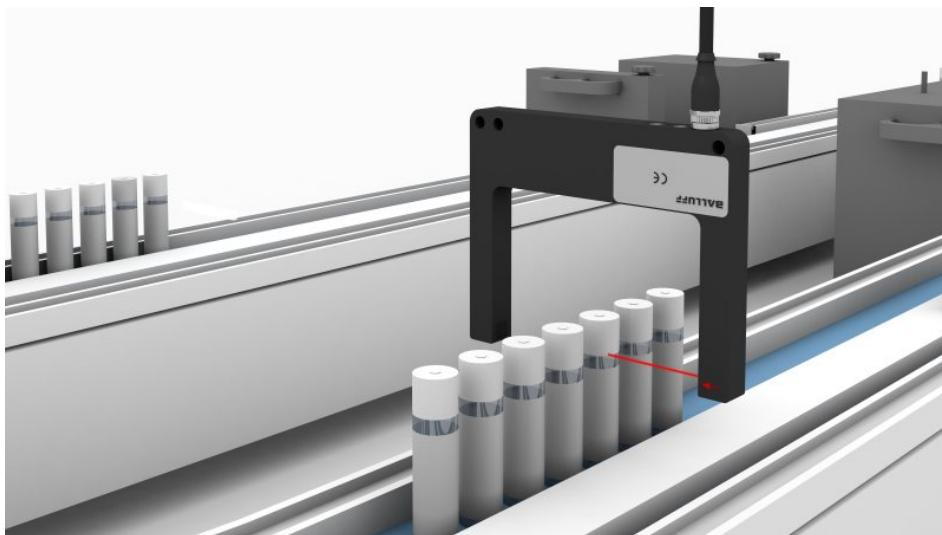
Gabellichtschranken werden z. B. bei der Durchgangs- und Staukontrolle an Förderbändern eingesetzt (Bild: Balluff).
