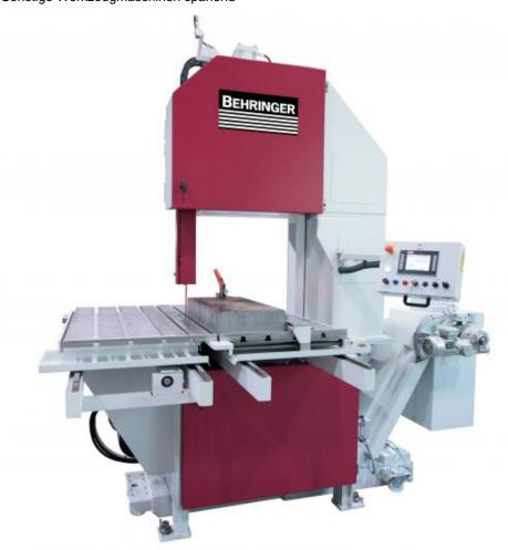
Behringer hat die kompakte Langschnitt-Plattenbandsäge »LPS-T« mit vertikalem Sägeband für den Werkzeugbau, für Probeschnitte, kleine Platten und Blöcke auf den Prüfstand gestellt und um einige Features anwenderfreundlich variiert. Nun zeigt sich die
