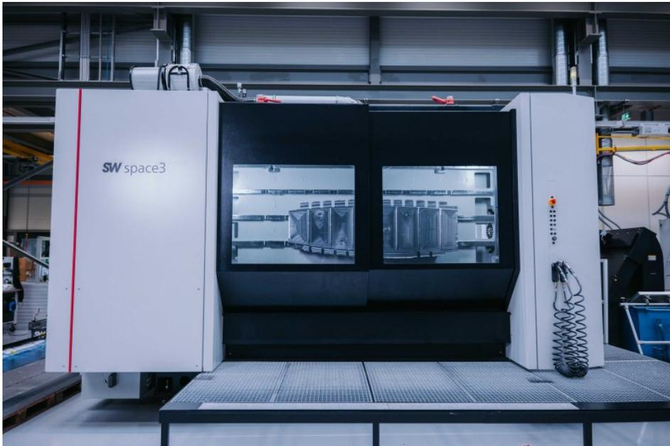
Das Bearbeitungszentrum eignet sich besonders für die Bearbeitung großer Werkstücke wie Flügelrippen (Bild: Schwäbische Werkzeugmaschinen).
