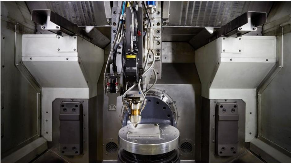
Versuchsanlage im H2Go-Projekt: Auf einer EHLA-Anlage werden Bauteile für Brennstoffzellen schnell und präzise mit Verschleißschutzschichten beschichtet (Bild: Fraunhofer ILT).
