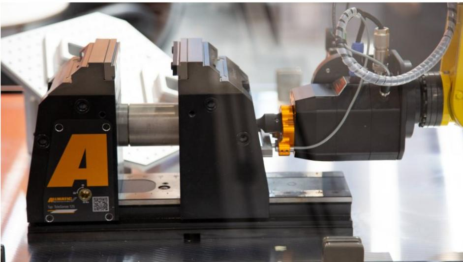
Die Erweiterung öffnet und schließt Schraubstöcke automatisch (Bild: Allmatic).
