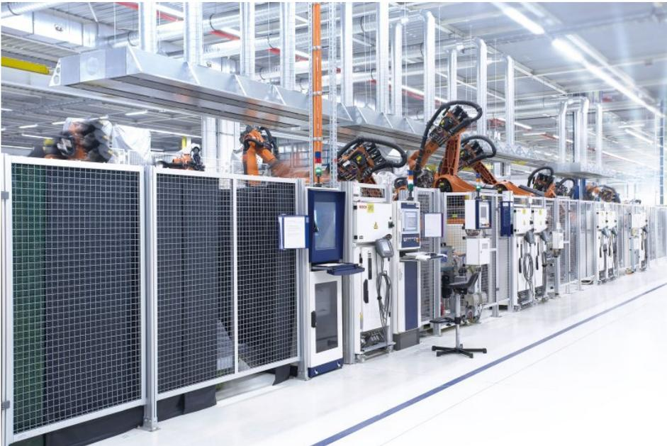
Beispielhafte Schutzeinrichtung für den Einsatz von Robotern (Bild: Minitec).
