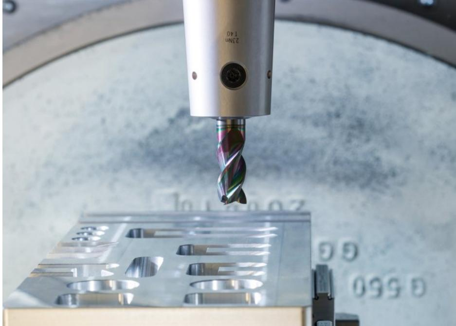
Vollmetallfräser mit innovativer Stirngeometrie und großen Spanräumen ermöglichen individuelles Fräsen, Rampen und Bohren mit einem Werkzeug (Bild: Mapal).
