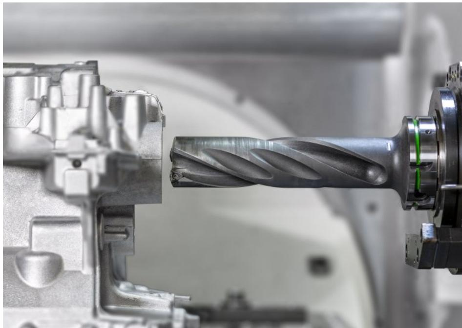
Schneiden mit Spanbrechergeometrie, hochpositive Schneidplatten und Wendeplattenbohrer erzeugen bei der Bearbeitung von Aluminium kurze kontrollierte Späne (Bild: Mapal).
