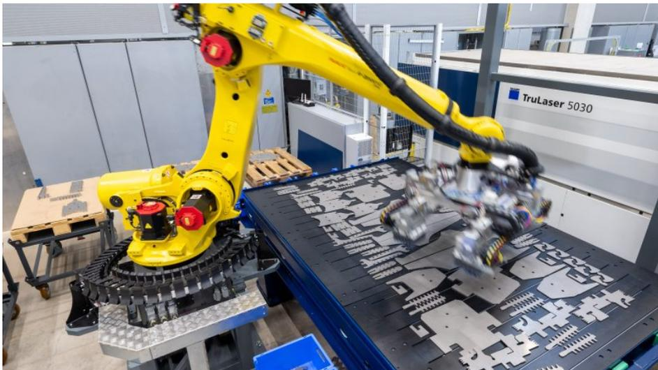
Die neuen Systeme ermöglichen ohne Programmierung das vollautomatische Absortieren von Blechteilen (Bild: Trumpf).
