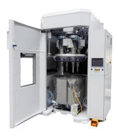
Die Femurteile werden an die Werkstückaufnahmen einer Arbeitsspindel aufgespannt. Die Bearbeitung erfolgt in einem mit Schleifkörpern bzw. Poliermitteln gefüllten Arbeitsbehälter (Bild: Rösler).
